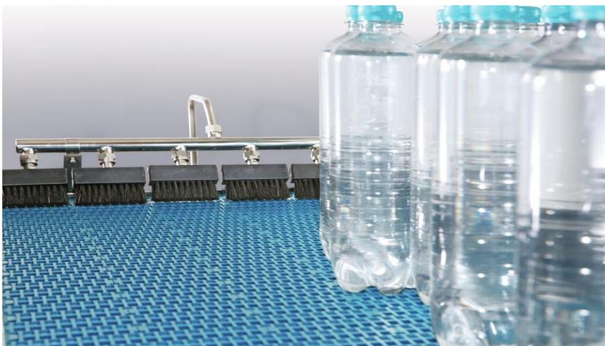
Переход с водорастворимой смазки на «сухую смазку» возможен, если выбранная смазка гарантирует смазывание всех вышеперечисленных критических точек. Понятно, что дозирование сухой смазки должно быть таким, чтобы остаточной смазывающей способности хватило как на верхнюю часть конвейера, так и на обеспечение снижения трения в нижней и боковых его частях.
