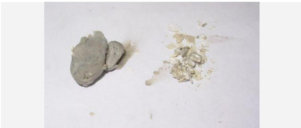
Пластичные и сухие отложения замещающих водорастворимых смазок
